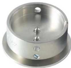
Werkhalter Zeiger setzen H7XXX.1A
