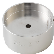
Werkhalter Stellwelle entfernen H ZXX.1T
