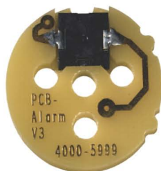
PCB-Alarm Insertion piézoélectrique de H5XXX.1A4 H5XXX.1P
