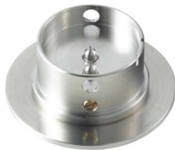
Werkhalter Zeiger setzen H6XXX.1A2
