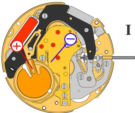
*Tige de mise à l'heure en position I, calendrier hors engrenage, intervalle de mesure 60 s pour la marche et la consommation:*
