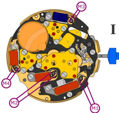
Résistance de la bobine M1      **1.90 k $\Omega$  .. 2.10 k $\Omega$**
