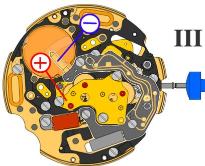
*Tige de mise à l'heure en position III, intervalle de mesure 60 s:*
