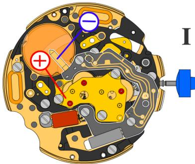
*Tige de mise à l'heure en position I, calendrier hors engrenage, intervalle de mesure 60 s pour la marche et la consommation:*
