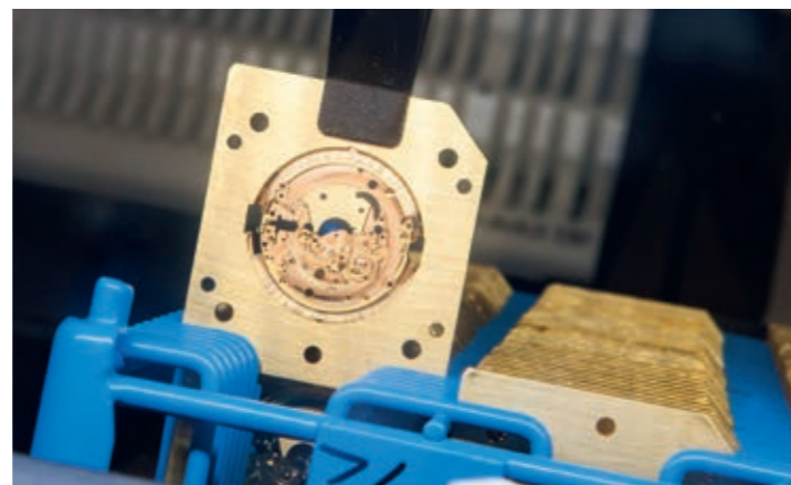
«Barquette» mit fertig gefräster Platine des Kalibers R150
