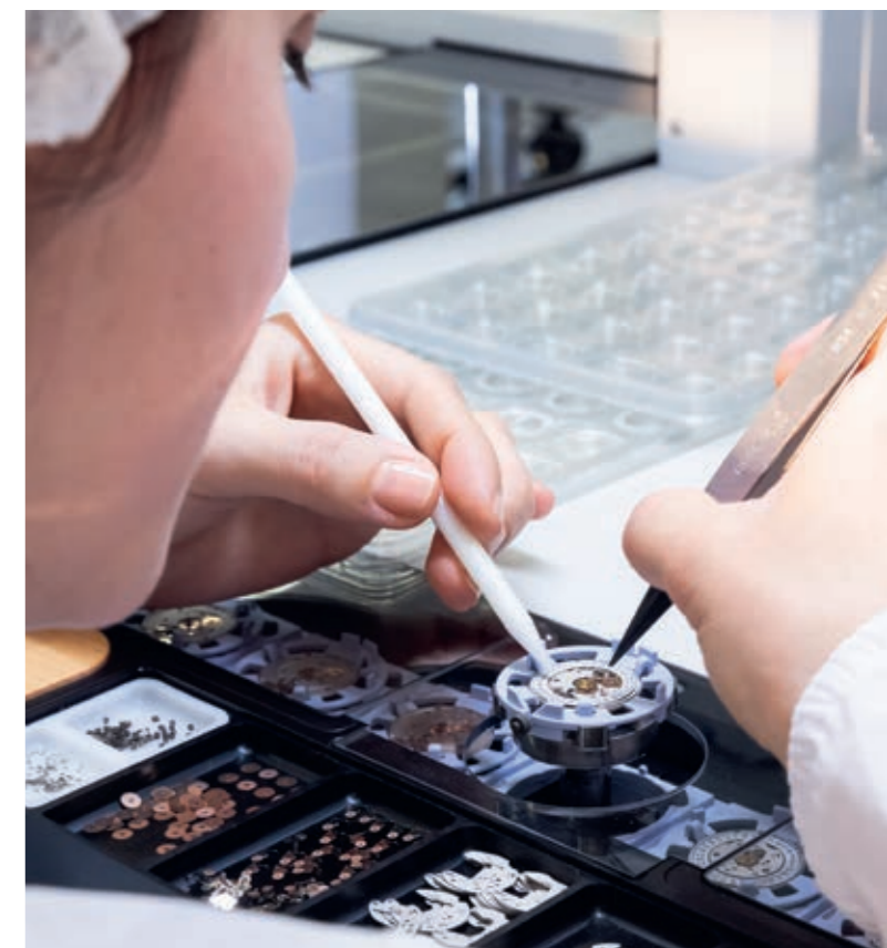
Rondas Mecano-Serien werden auf einer halb automatischen Montagelinie zusammengebaut.
