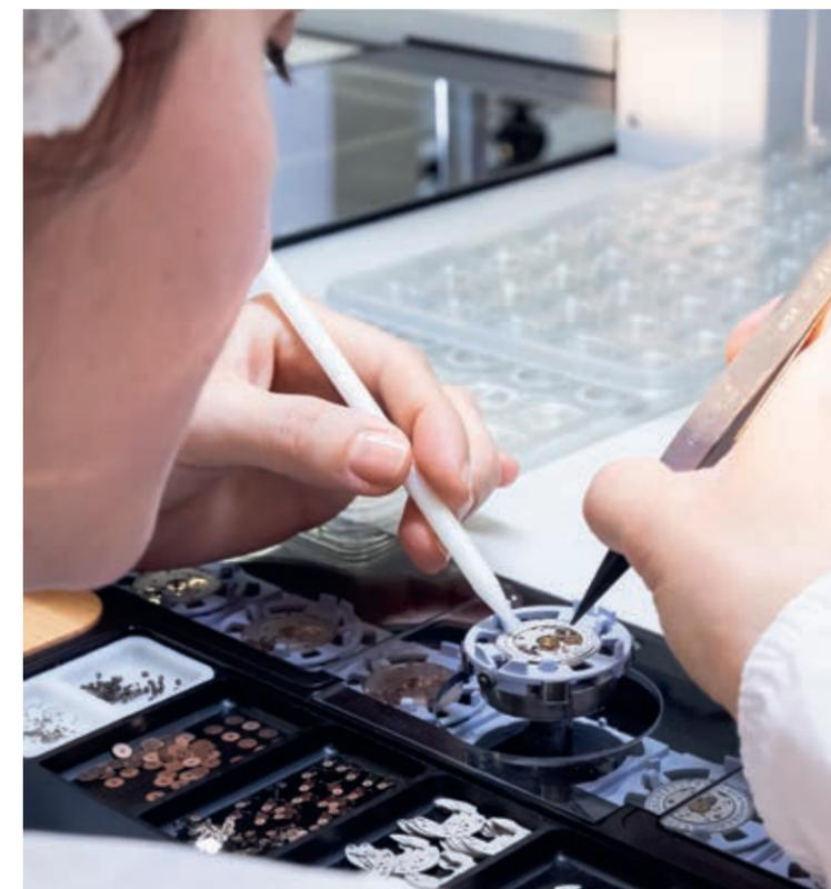
La série Mecano de Ronda est assemblée sur une ligne de montage semi-automatique.
